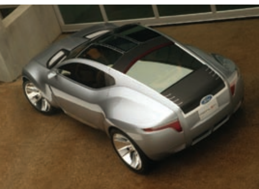
Дизель-электрический гибрид-прототип Ford Reflex может оказаться более экономичным, чем гибридный автомобиль с бензиновым двигателем. Этот прототип может проехать 100 км на одном галлоне дизельного топлива, а в это же время солнечные батареи будут заряжать его батарею
