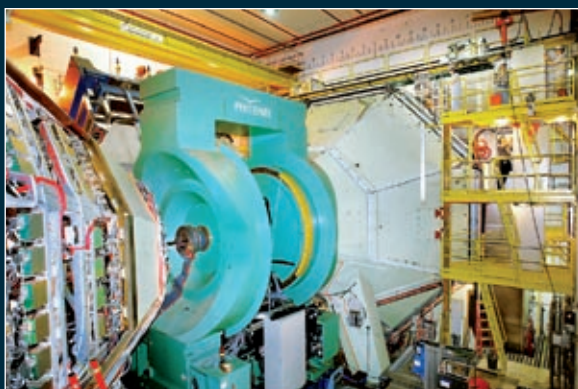
Установка PHENIX (показана в частично разобранном виде) регистрирует частицы, возникающие на самых ранних стадиях мини-взрывов
